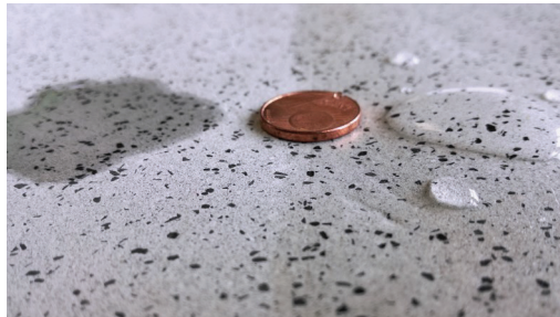
Po lewej - bez ochrony woda wniknęła w powierzchnię Po prawej - chronione z COLORFRESH® intensiv woda nie wniknęła
